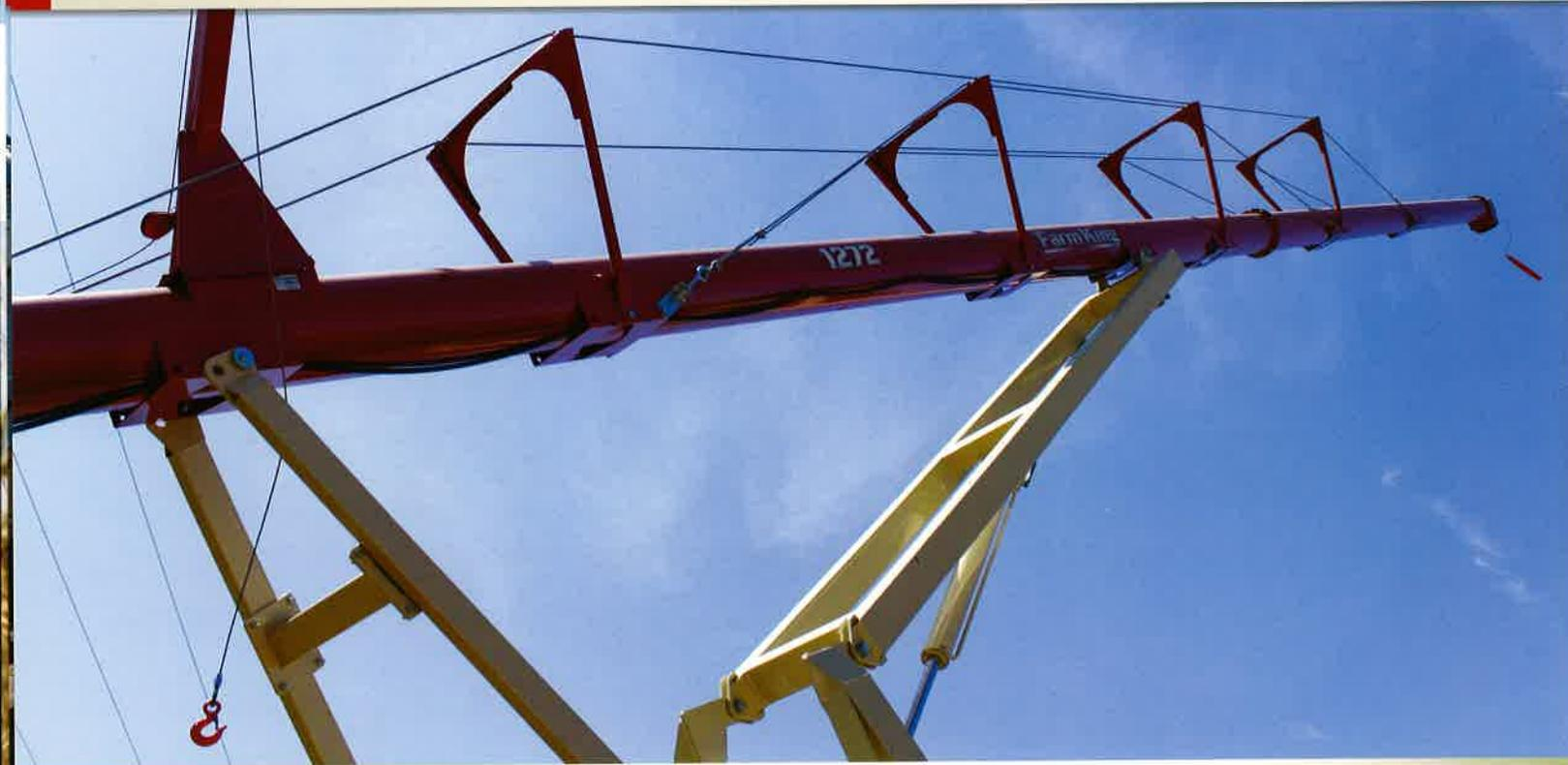
**Vis Backsaver 10 / 12.** Les vis Backsaver Farm King sont pratiques, économiques et fiables. Les longueurs de ces vis passent de 18,9 à 28 m (62 à 92 pieds). La trémie d'admission invite de grandes quantités de grain à être rapidement déplacées sur la vis et dans le conteneur. Tous les modèles sont fabriqués en utilisant une vis hélicoïdale de 35,5 cm (14 po).
