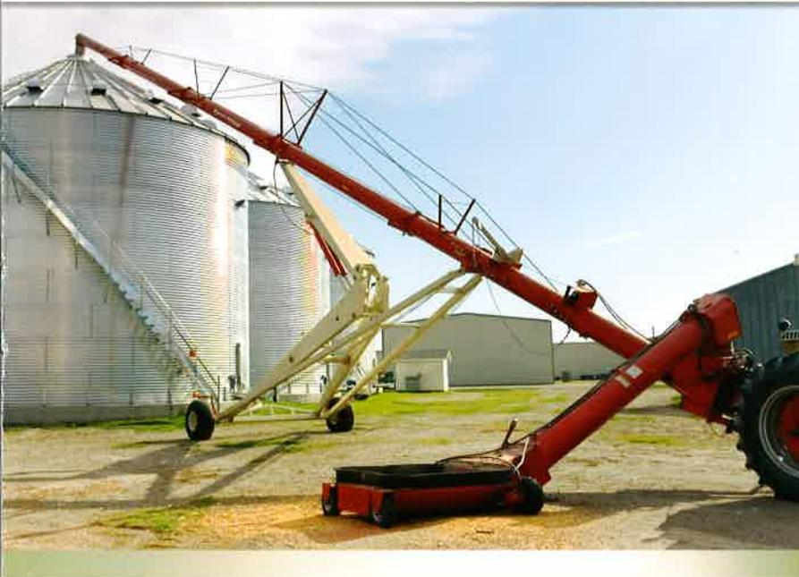
**Modèle 16104** La vis à grain 16104 Farm King est conçue par des gens qui connaissent et comprennent vos exigences de la manutention du grain. Le large tube de 40,6 cm (16 po) d'une longueur de 31,7 m (104 pi) permet à l'utilisateur de déplacer de grandes quantités de grain en peu de temps. Équipée d'un arbre de vis hélicoïdale de 3 po la vis Farm King peut manier avec facilité mêmes les récoltes les plus humides.
