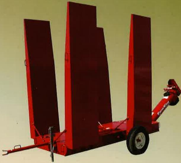
**Trémies à pont.** La trémie à pont de 25,4 ou 30,5 cm (10 ou 12 po) sera dégagée sous un camion ayant un empattement de 6 m (19 pi 6 po) et un dégagement de 20 cm (8 po). Les camions ayant un empattement plus court auront un meilleur dégagement. Levage hydraulique de l'unité.
